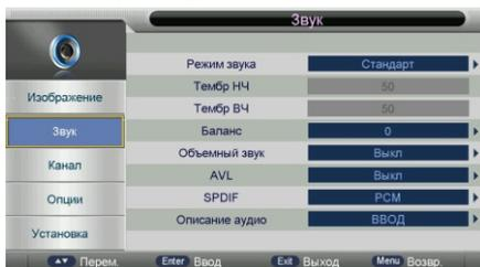
**Режим звука** – Выберите подходящий режим в зависимости от типа просматриваемых передач: Стандартный, Фильмы, Музыка или Пользовательский. Вы также можете изменить режим изображения, последовательно нажимая кнопку S-MODE на пульте ДУ.
