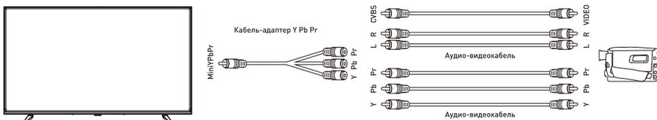
Подключите видеокамеру к телевизору, используя кабель-адаптер Y/Pb/Pr или кабель-адаптер AV (кабели-адаптеры в комплект поставки не входят).
