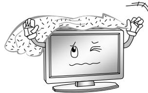
8. Не устанавливайте изделие вблизи источников тепла, таких как радиаторы, обогреватели, печи или другие приборы (включая усилители), излучающие тепло.
