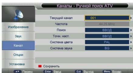
**Текущий канал** – Установите номер канала, с которого нужно начать поиск.
