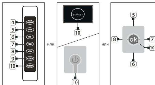
**STANDBY** - Кнопка включения телевизора
