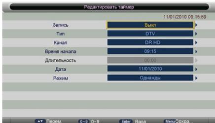
В открывшемся меню включите начало видеозаписи, установите режим телевизора, телеканал, время начала видеозаписи, ее продолжительность, дату, а также режим видеозаписи (разовый или регулярный). Вы можете запланировать запись нескольких передач, при этом будьте внимательны: время передач не должно накладываться одно на другое. Телевизор мо
