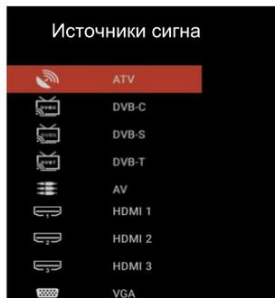
2. Нажмите кнопку **INPUT** на ПДУ или на панели телевизора для вызова на экран меню источников сигнала. Нажмите кнопку ▼▲ на ПДУ или кнопку **CH-/CH+** на телевизоре для выбора источника сигнала. Для подтверждения нажмите кнопку **OK** на ПДУ.
